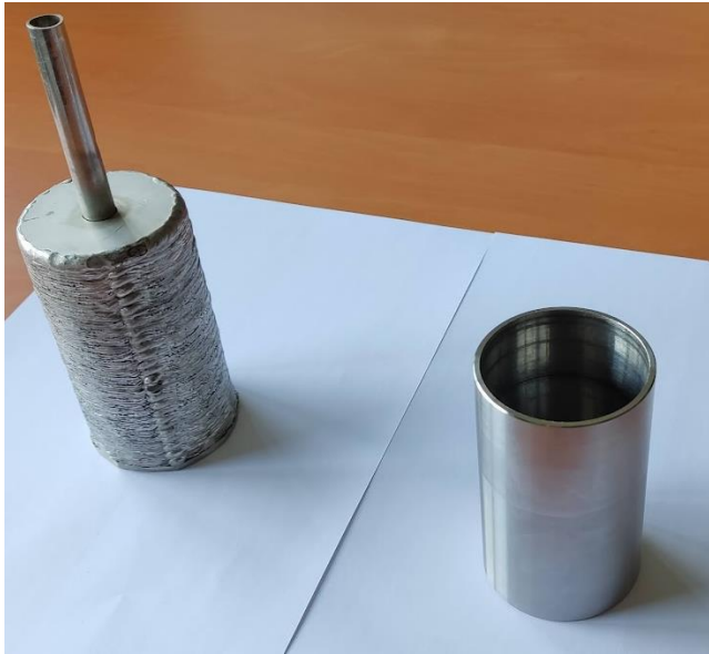
A droite le conteneur précédant après reprise d'usinage A gauche, un second conteneur imprimé en paramétrie fine (3-4 mm au lieu de 7)
