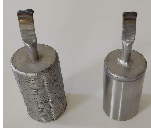
2 conteneurs de poudre fabriqués par WAAM: l'un avec reprise d'usinage, l'autre sans
