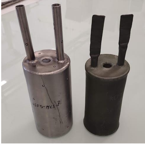
Conteneurs de poudre avant et après frittage CIC (fabrication conventionnelle)
