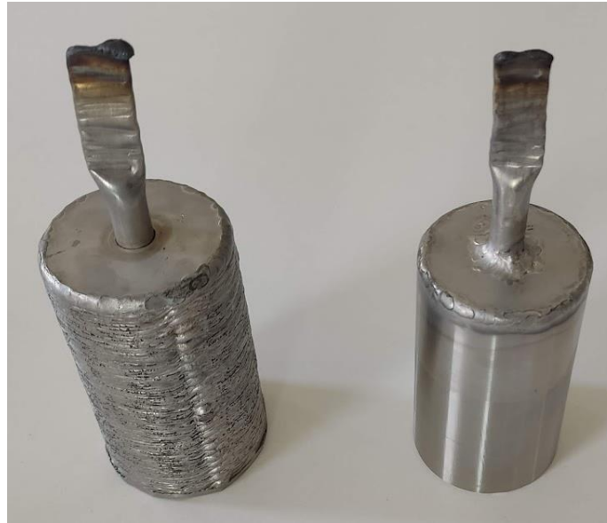
Les 2 mêmes conteneurs après remplissage de poudre et mise sous vide
