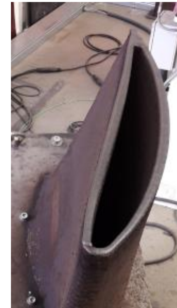
Pale déposée par WAAM (modèle ½) / Vision de la géométrie creuse / Pale après usinage, Centrale Nantes
