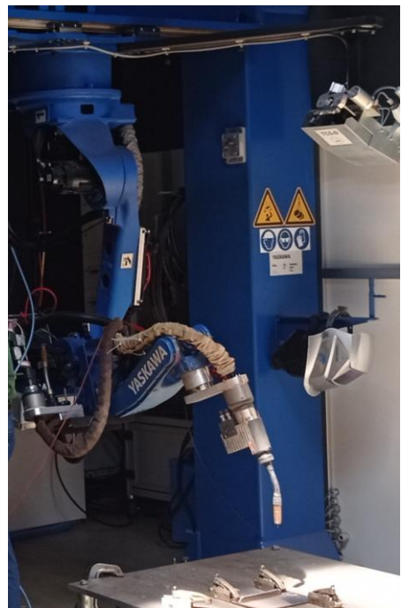
Equipements WAAM : Cellule robotisée Yaskawa et générateur type CMT, Centrale Nantes
