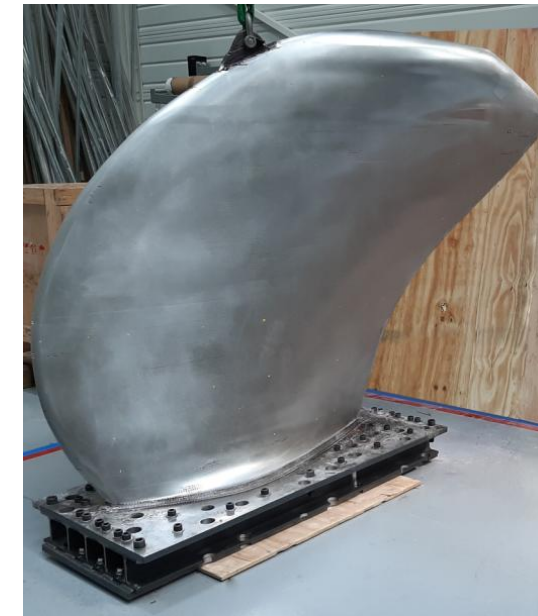
Pale déposée par WAAM (modèle ½) / Vision de la géométrie creuse / Pale après usinage, Centrale Nantes
