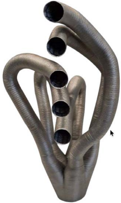
Collecteur 5 en 1 DED-LP (AddUp). La pièce fait 380 mm x 240 mm. 15 h de fabrication.
